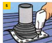
5 Pripevniť k podkladu skrutkami (min. vzdialenosť 38mm, pri plechových strechách použiť skrutky DIN7504-K)
