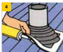
4 Utesniť na okrajoch (doporučujeme použiť Stick-Fix, ktorý je pružný a odolný voči UV žiareniu)
