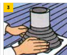
3 Nastaviť ručne podľa tvaru strechy
